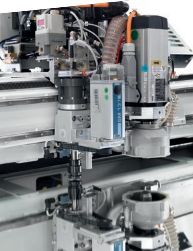
Mithilfe von optionalen Vorrichtungen kann Genius CT-PLUS Abtragungen des Wärmeschutzes (Low-E) für jede spezifische Produktionsanforderung durchführen.
