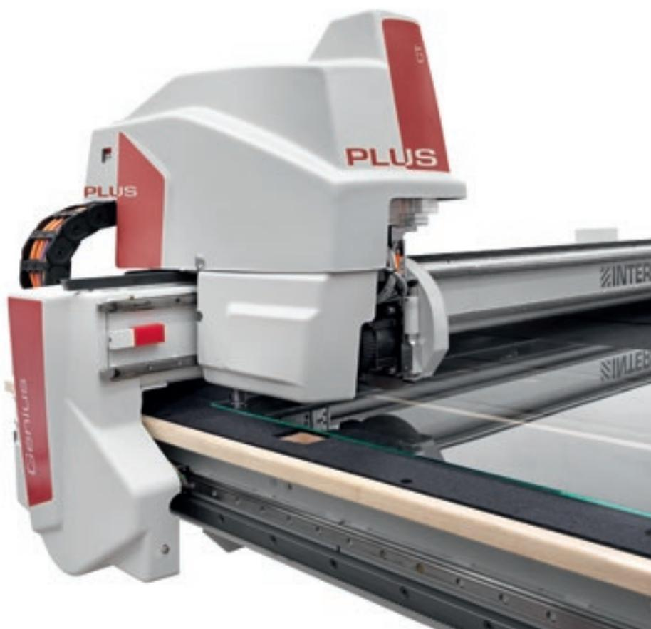
Die automatischen Füßchen, die als Scheibenaufgabe während der Schwenkbewegung des Tisches und als mechanische Ausrichter der Scheibe fungieren.
