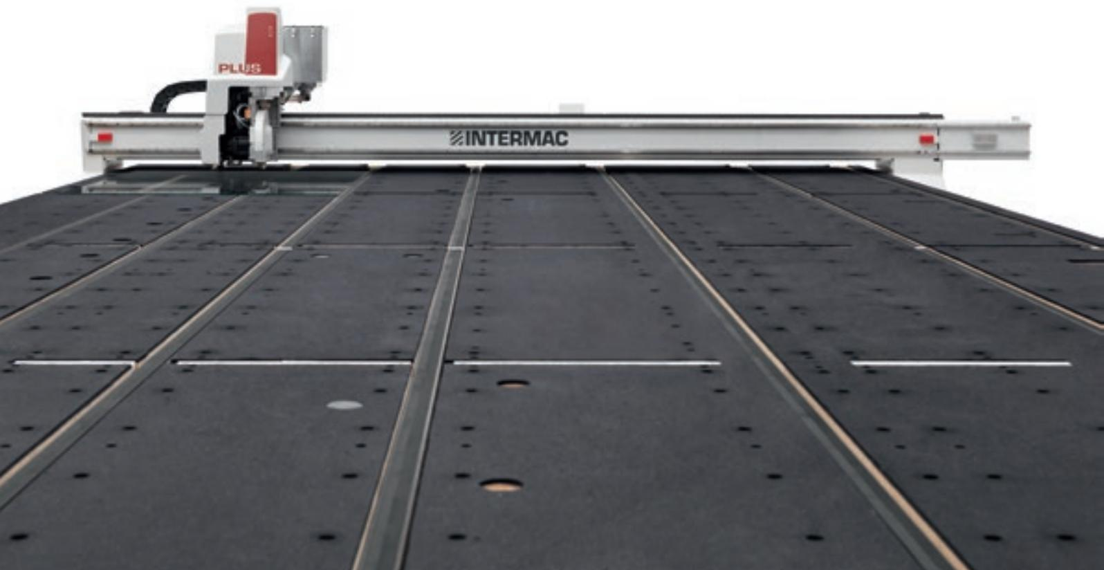
Der Unterbau der Maschine besteht aus einer steifen, begradigten Struktur, auf dem geschliffene Holzplatten angebracht werden, die die maximale Planheit des Arbeitsbereichs gewährleisten, was eine unbedingte Voraussetzung für ein optimales Gelingen der Bearbeitung und des Glasschneidens ist.
