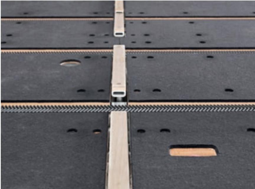
Durch das integrierte Riemensystem lässt sich die Glasplatte einfach auf der Linie befördern.
